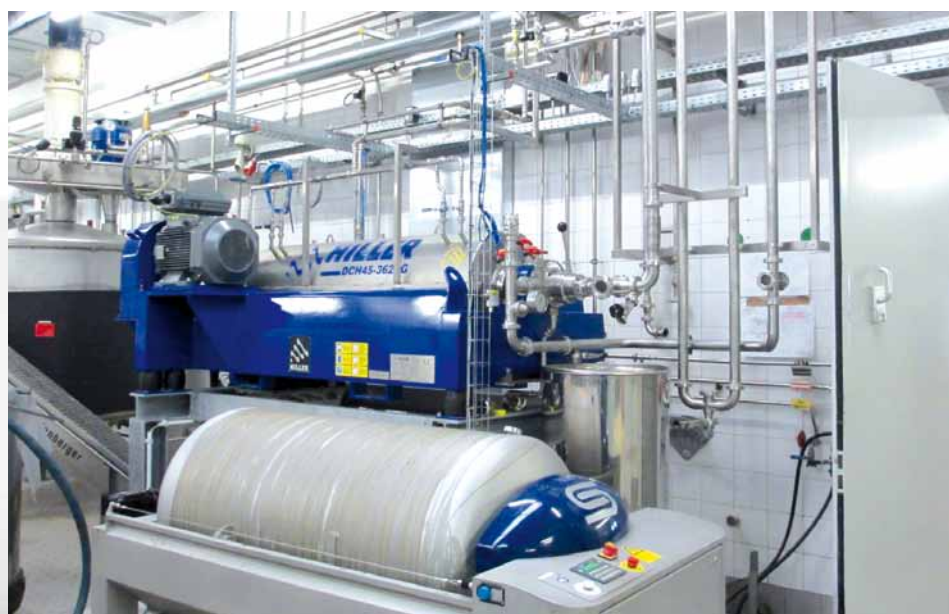
Decanter HILLER in un processo chimico
